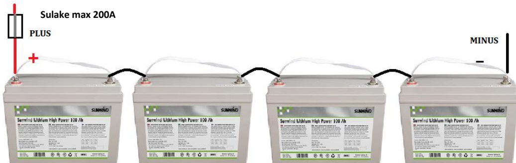
4KPL AKKUA SARJAANKYTKENTÄ 48V
