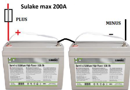
2KPL AKKUA SARJAANKYTKENTÄ 24V
