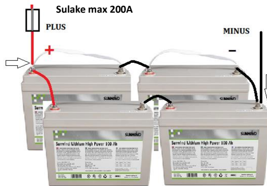
4KPL AKKUA SARJAANKYTKENTÄ 24V
