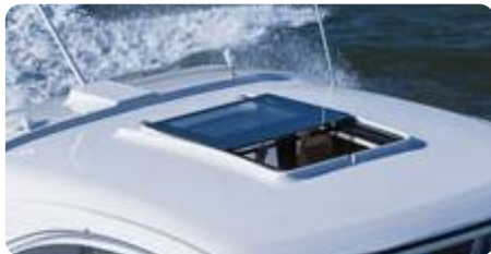
20 Sarja: Vakiokokoinen, edullinen käsi- tai sähkökäyttöinen flushluukku. Karkaistu savulasi. Portaaton lukitus avattuna.
