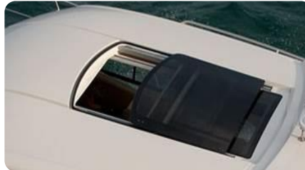
40 Sarja: Vakiokokoinen 12v sähköluukku. Karkaistu savulasi, D-muoto. Asennus 1320x915mm R 7620mm aukkoon.
