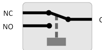
Ohjelmoitavan releen sisäinen toiminta
