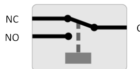
Releen konfigurointi (jännitteetön)
