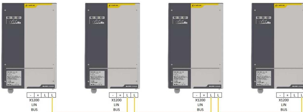
**Etape 3 :** Un seul chargeur doit être désigné maître, les autres seront esclaves (voir configuration des micro-interrupteurs SW1202, tableau au paragraphe 3.3.1) ;
