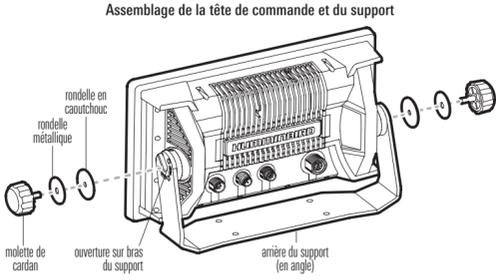
Si vous préférez monter le tête de commande en hauteur, faites pivoter le support au-dessus de la tête. L'ouverture dans les bras de support doit faire face à l'arrière de la tête de commande.
