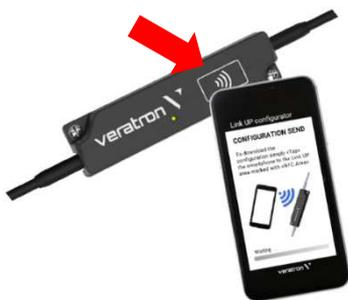
1. Starten Sie die App "Link Up Configurator" und lesen Sie die aktuelle Konfiguration des LinkUp-Geräts aus, indem Sie das Smartphone auf den LinkUp-Funkbereich "tippen" (durch den roten Pfeil gekennzeichnet).
