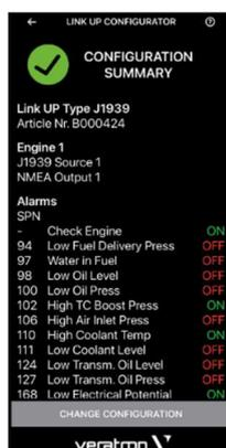
Um die Konfiguration zu ändern, drücken Sie die Schaltfläche "Change Configuration".
