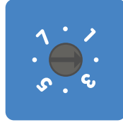
Kiertokytkin asetettu asentoon 2
