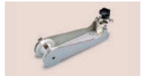
Musone in acciaio inox AISI 316 lucidati a specchio lungh. 330 largh. 80 sp. 4 mm con 1 bloccaggio. Per ancore Bruce/ Danforth fino a 10 Kg Cod. 229.06 Polished stainless steel AISI 316 bow roller length 330 width 80 thickness 4 mm with bloking device. For anchors Bruce/ Danforth up to 10 Kg Cod. 229.06
