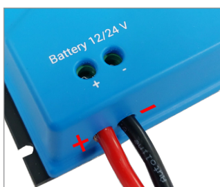
[Kuva 17] Kytke huolellisesti latausjohtimet oikeisiin reikiin + ja - johtimet niille varattuihin paikkoihin.
