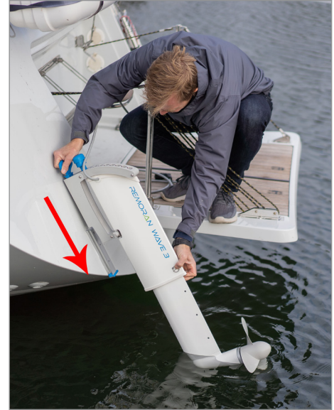
[Kuva 27] Aseta ulkoyksikön runko kiskoon yläpäähän ja liu'uta se alas kiskoa pitkin.
