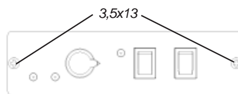
Kuva 5: 86D:n ohjauspaneelin kiinnittäminen pöytään.
