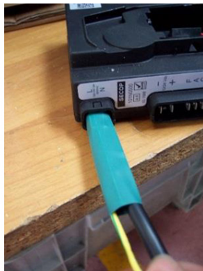
Figur 11: Detalj av anslutning med dubbel isolering
