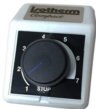
Figur 8: Exempel på termostat som används i Compact Classic, med skala för inställning från 1 (varmast) till 7 (kallast)
