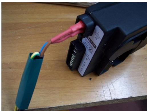
Figur 11: Detalj av anslutning med dubbel isolering
